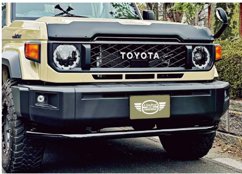
■RICK'S フロントガードバーKIT ¥88,000(税込) コードE 純正バンパー下部に装着するガードバーKIT。 スチール製の60.5パイのパイプ材で頑強な仕上で下部からの接触をガードするアイテム! カチオン電着+焼付塗装仕様で膜厚強化。
