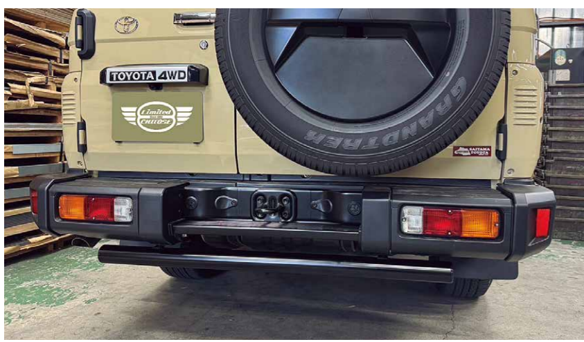
■RICK'S リヤガードバーKIT スチール製 カチオンBK+焼付BK塗装 ¥33,000(税込) コードC リヤバンパー下部へ装着するパイプ形状のガードタイプパーツ! シンプルな60パイのスチールパイプにカチオン電着塗装。 フロント廻りと合わせても活きるオフ感演出のアイアンパーツ!
