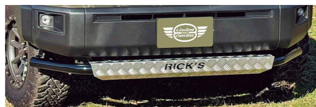
■RICK'S フロントプレート 各 ¥35,200(税込) コードC スチール製 カチオン電着+焼付塗装/アルミ製素地【縞板】
