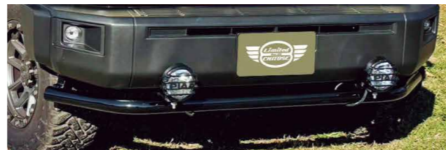
■RICK'S フロントガードバー専用ライトステー ¥8,800(税込) コードB フロントガードバー用のライトステー(加工無)ガードバーヘライトを装着したい方は便利です。 スチール製カチオン電着の4mm厚なのでプレも軽減。
