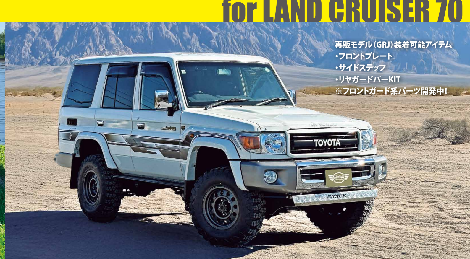
■RICK'S サイドステップ左右セット ¥74,800(税込) コードD スチール製縞板鋼板ブラック塗装 RICK'Sロゴ入り 発売16年目の伝統形状、純正ステップを外しボルトオン装着! 足付性向上、サイドビューがスッキリ、視覚効果で車高が高く見える優れものです。
